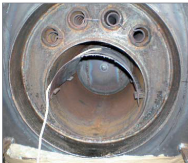
Slika 10: Kondenzacija dimnih plinova kod ispitnog prototipa NTK25
